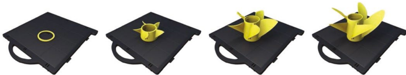
Faze izrada fizikalnog modela aksijalne redakcijske turbine
