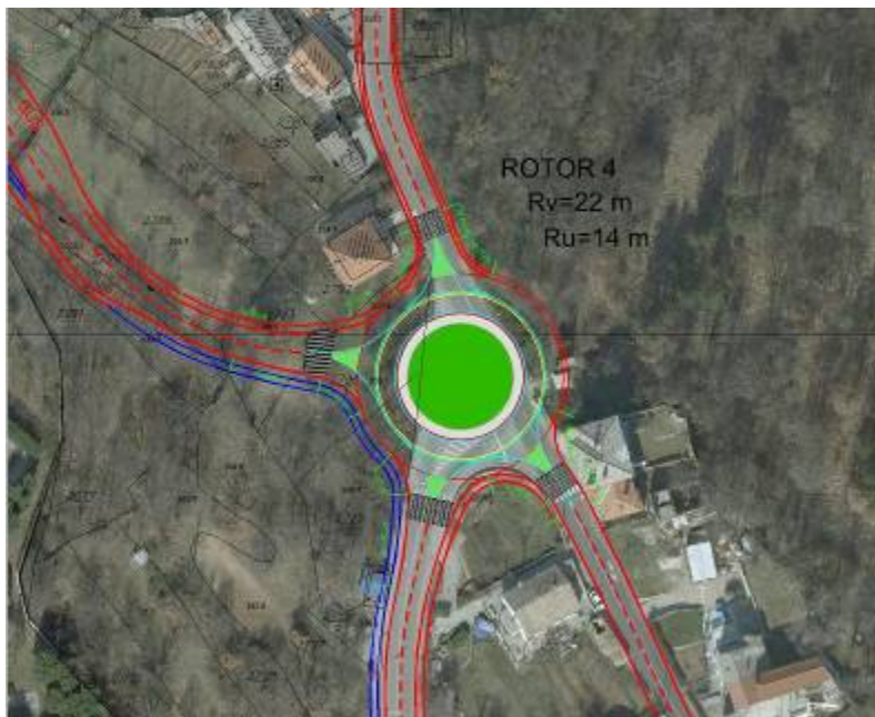
Kartogram 11: Prijedlog uređenja raskrižja postojeće Ulice Drenovski put i planirane ulice oznaka OUXVIII – ROTOR 4
