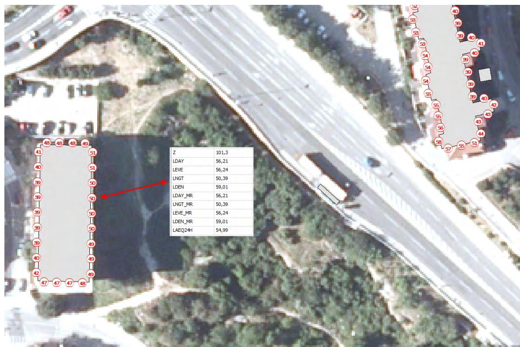
Slika 31. Prikaz razina buke temeljen na tzv. fasadnom proračunu
