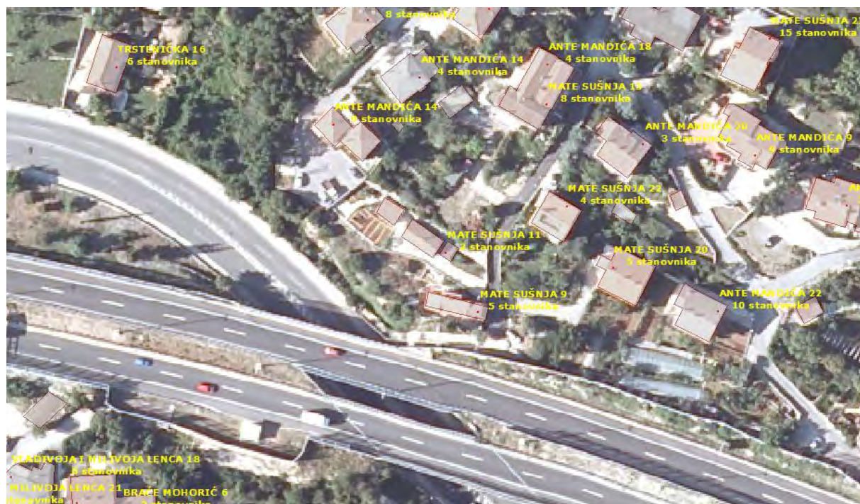
Slika 22. 2,5D model građevinskih objekata s adresnim modelom
