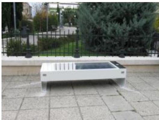
Odjel gradske uprave za komunalni sustav postavio je na pet lokacija u gradu pametne klupe sa 4 punjača mobitela (bežični i USB), brzim internetom, solarnim panelima i ambijentalnim svjetlom. Pametne klupe imaju čeličnu plastificiranu konstrukciju sa sjedalom od pleksiglasa.
