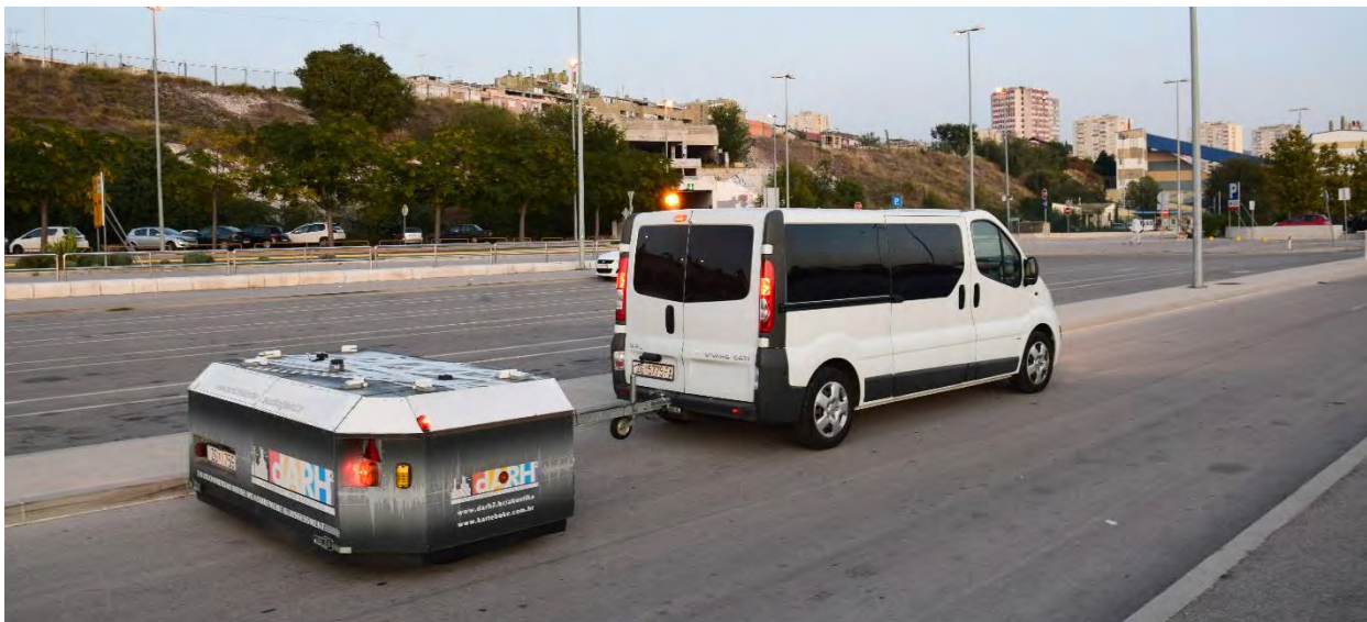
Slika 17. Prikaz mjerne prikolice za mjerenje CPX parametara
