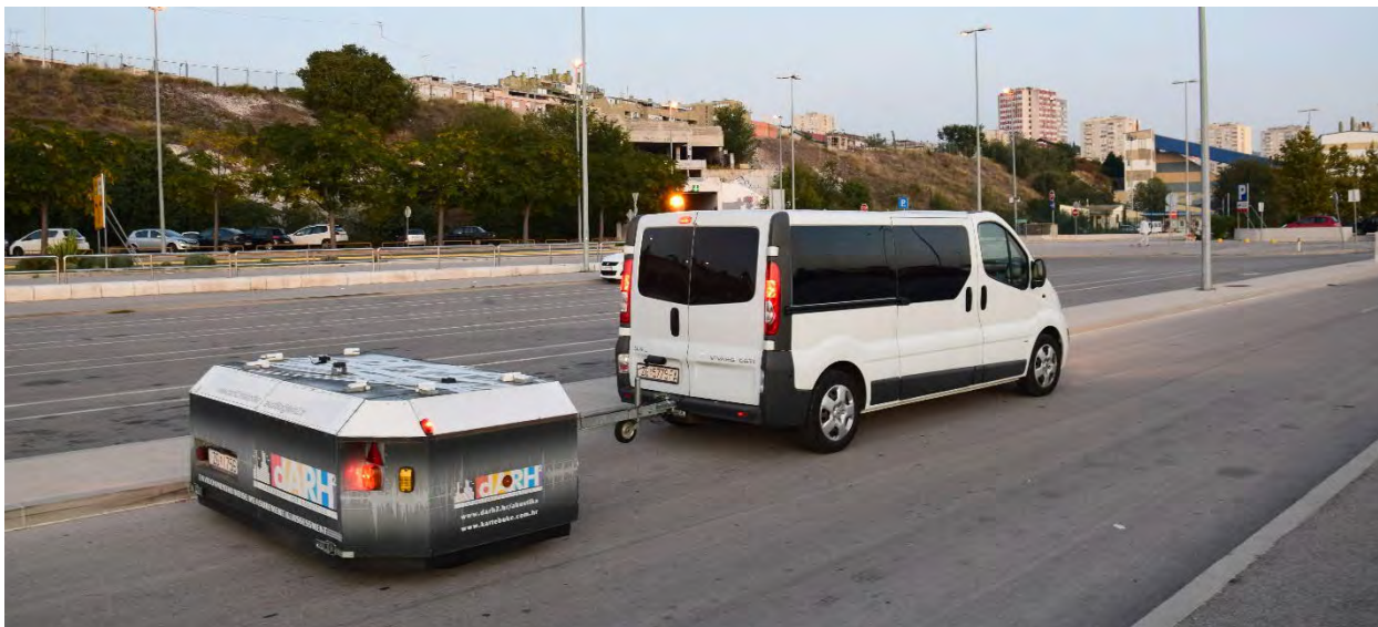
Slika 17. Prikaz mjerne prikolice za mjerenje CPX parametara
