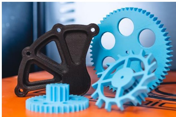
Fotografija 19.: Isprintani 3D modeli od različitih vrsta polimerskih materijala
