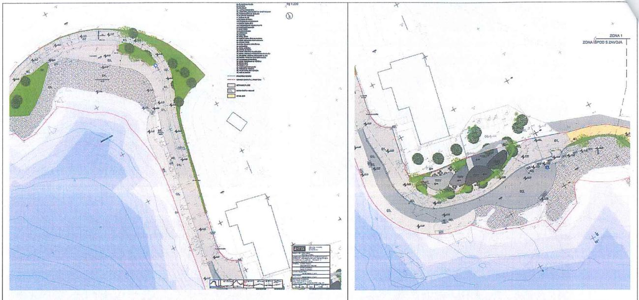
Nova sunčališta projektirana su kao armirano-betonska konstrukcija, sa zidovima debljine 35 cm i pločom od 20 cm, većim dijelom temeljeni u moru, na trakastim temeljima presjeka 100x60cm (Tip B1) i 150x60cm (Tip C1), izvedenim do nosive stijene (procijenjena dubina je 80cm od gornje razine mora). Završna ploha sunčališta je čisti beton izveden in-situ. Ukupna površina sunčališta iznosi oko 900 m<sup>2</sup>.
