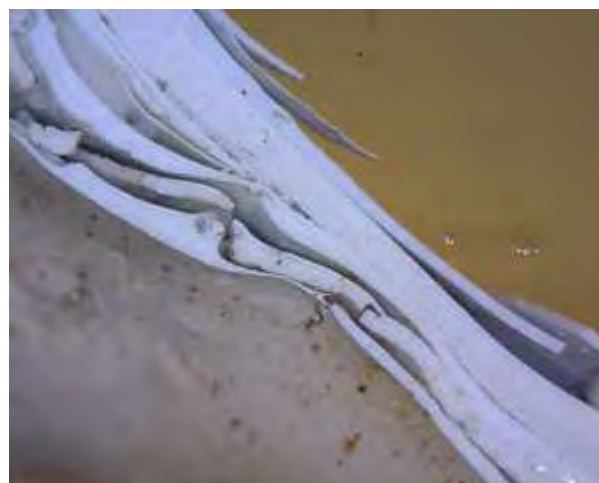
Slika 62, Mikropresjek bojanog sloja sa vanjske stijenke nadgrađa palube čamaca, izvor: eLABORO d.o.o.
