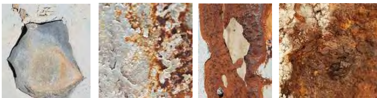
Slika 9, Različite razine degradacije metalnih površina vanjskog dijela nadgrađa, izvor: eLABORO d.o.o.
