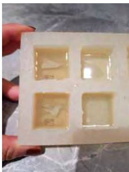
Slika 63 a, b, Izrada mikropresjeka uzorka bojanog sloja, izvor: eLABORO d.o.o.
