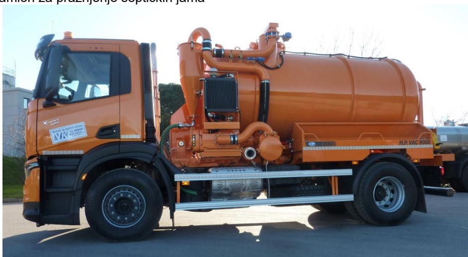
Slika 4: Kamion za pražnjenje septičkih jama
