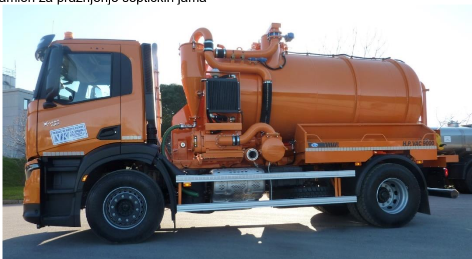
Slika 4: Kamion za pražnjenje septičkih jama
